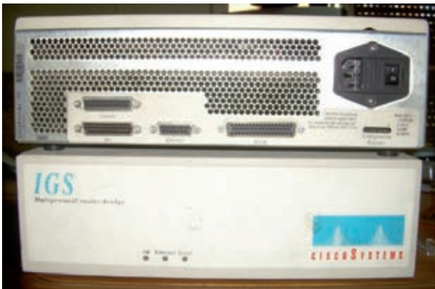
Uno de los primeros routers que tuvo RedIRIS, que a la vez fue uno de los primeros routers multiprotocolo de Cisco, el Cisco-IGS (lanzado como producto comercial a mediados del año 1990). Cortesía de Jesús Sanz de las Heras.
